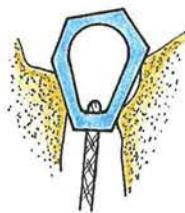
De forme hexagonale aux faces excentrées, il s'adapte à plusieurs largeurs de fissures.
