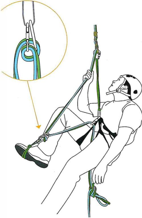
Astuce : passer la corde dans un mousqueton sur le pontet pour faciliter sa récupération lors de la remontée du nœud de cœur.
