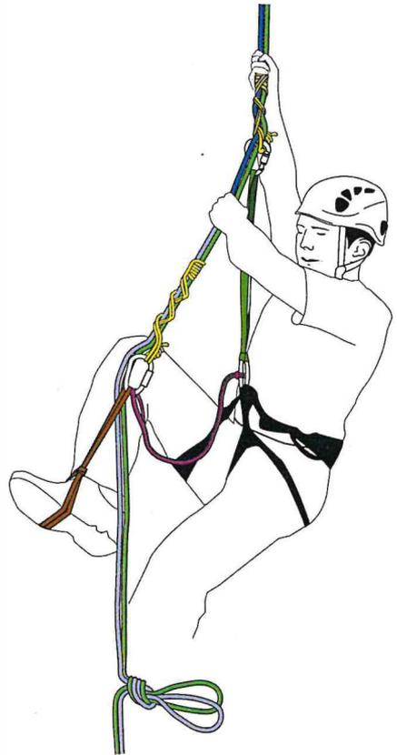
Quelle que soit la méthode, réaliser un nœud sur la corde en cas de défaillance des autobloquants.
