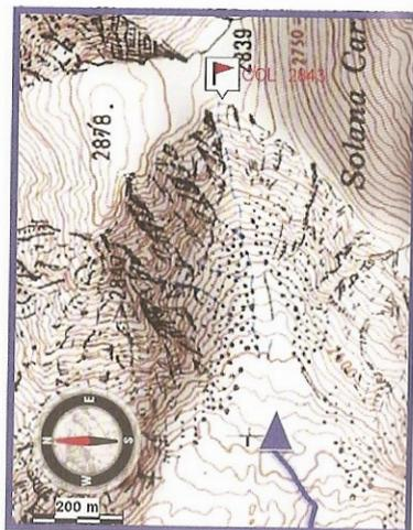
**Waypoint (Wpt) :** ce point de passage (ou de destination, ou POI : Point Of Interest) correspond à un point caractéristique sur la carte papier, qui est identifié (Icône et Nom) et repéré (Coordonnées) sur la carte du GPS. Les « identifier » par un nom et / ou un icône dédié permet d'en faciliter l'identification car ils sont créés par incrémentation WPT001 > WPT002, etc. Pour le rejoindre, zoomer pour voir à la fois sa position, le Waypoint visé et l'échelle afin d'évaluer la distance.
