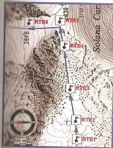
**Route (Rte) :** il s'agit d'une suite de waypoints successifs, jalonnant le parcours prévu. L'itinéraire se déroule sous la forme d'une succession de droites. Le GPS indique la distance et la direction du prochain Waypoint. L'arrivée finale sur chaque Wpt entraîne le basculement automatique sur le Wpt suivant. (Attention trop de Wpt rapprochés incombrent l'écran).
