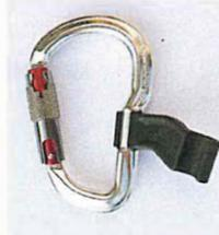
**Mousqueton directionnel** : le loquet permet de maintenir le mousqueton dans le meilleur axe de travail. Attention à ne pas confondre loquet et doigt dans les passages de cordes !
