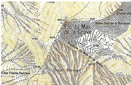
Pour représenter le relief, on utilise des courbes de niveau et/ou un ombrage aussi appelé estompage. Les versants éclairés s'opposent aux versants à l'ombre. Par convention, sur les cartes, l'éclairage vient du nord-ouest avec un angle de 45°.
