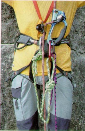
le en position verticale grâce à une sangle passée directement dans son anneau supérieur. Puis passez cette sangle dans le dos et la ceinture du baudrier. Ainsi, quelle que soit la position du corps, le crows reste au mieux plaqué contre
