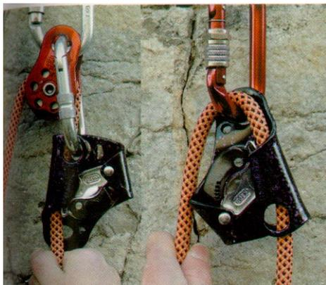
4 . Tête de mouflage avec une plaquette auto-bloquante. La plaquette autobloquante doit être considérée comme une solution de dépannage car son rendement est faible par rapport aux autres.
