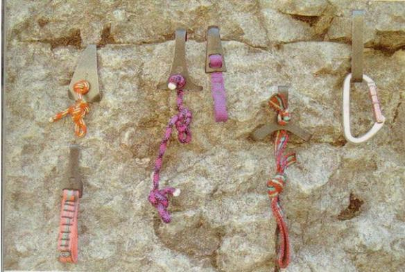
Ces crochets servent de points d'ancrage sur le rocher lorsqu'il n'y a plus d'autres possibilités pour progresser avant l'emploi d'un scellement sec (spit ... ). On distingue plusieurs types de crochets:
