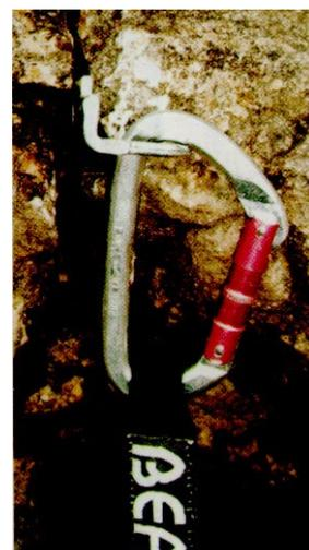
**Piton horizontal planté dans une fissure verticale avec un mousqueton.**
