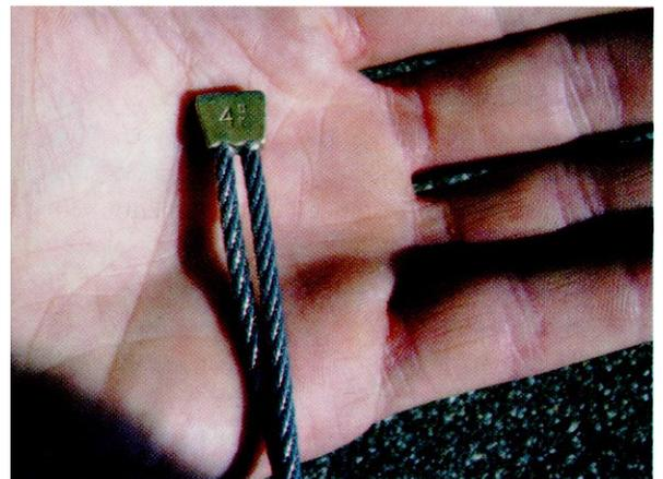
De forme très classique, ils se caractérisent par une tête en alliage de cuivre où le câble d'amarage est directement serti, facilitant ainsi leur placement dans la fissure. Cet alliage de cuivre étant malléable, la tête, sollicitée par une forte traction, épouse la forme de la fissure. Sa résistance à l'arrachement est augmentée mais
